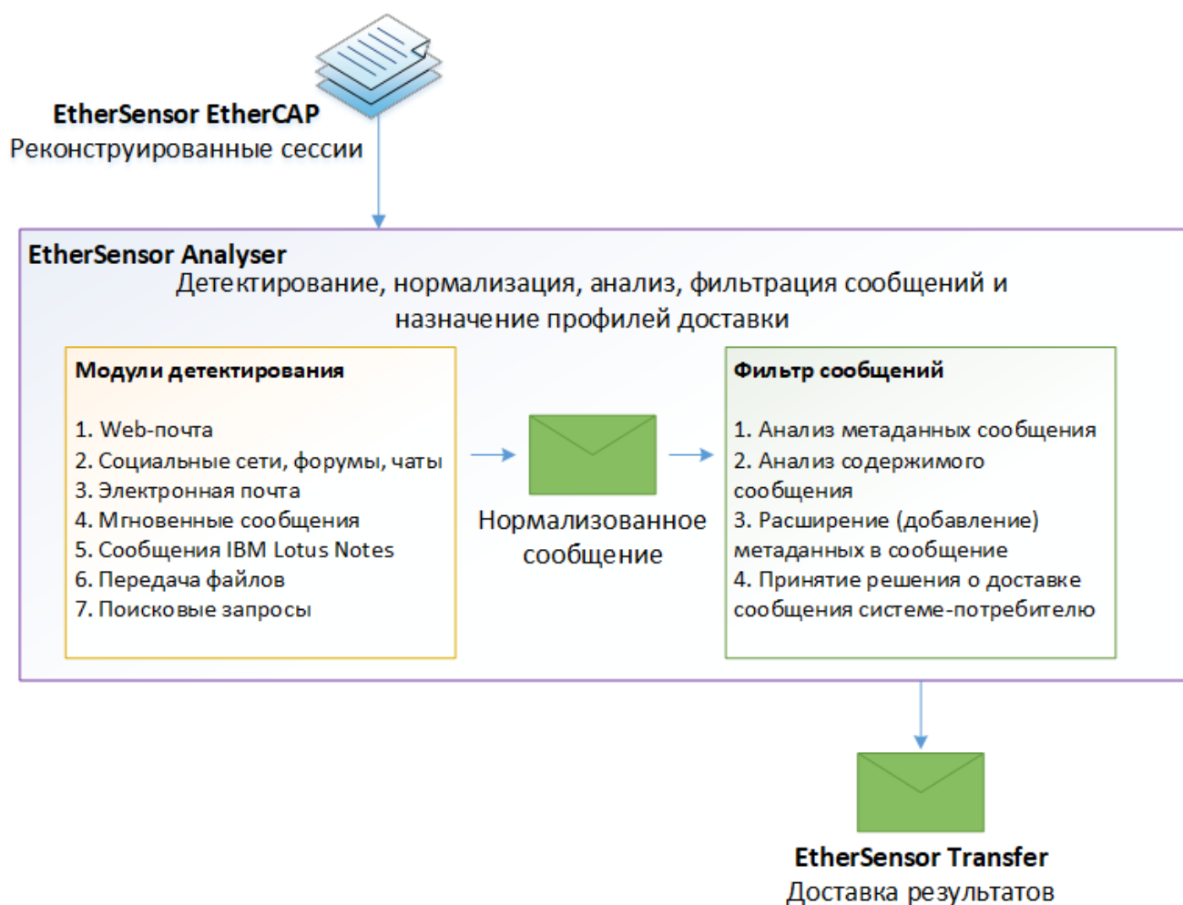
Рис.30. Схема работы службы EtherSensor Analyser.
